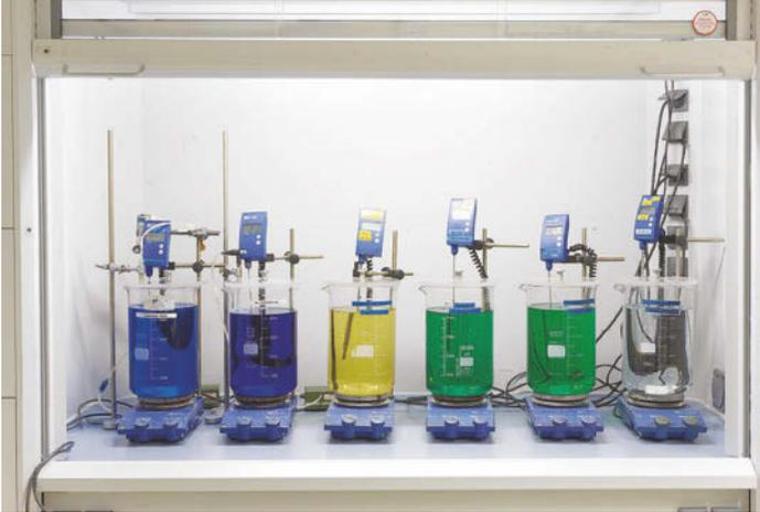
**Bild 2.5** Mit einer Kaskade von Bädern lassen sich zusätzliche Metalle auf Leiterplattenmaterialien abscheiden
