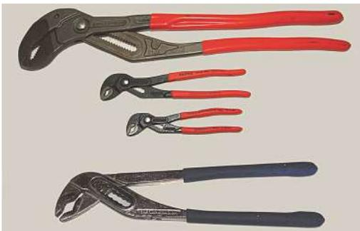
**Bild 1.19** Die Backenachsen hochwertiger Zangen sind gegen Lösen mit speziellen Achsköpfen gesichert. Die Backenachse der unteren Zange ist dagegen lediglich verpresst. Nach ein paar Anwendungen hatte sie sich bereits gelöst.
