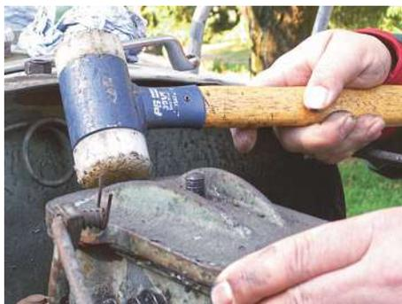
**Bild 1.22** Kunststoffhämmer garantieren gelenkschonendes Arbeiten. Ihr Einsatzspektrum ist jedoch beschränkt. [13]
