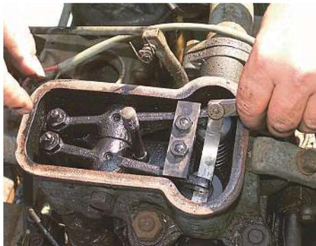
**Bild 1.35** Ein Satz hochwertiger Fühlerlehren darf in keiner gut ausgestatteten Kfz-Werkstatt fehlen.
