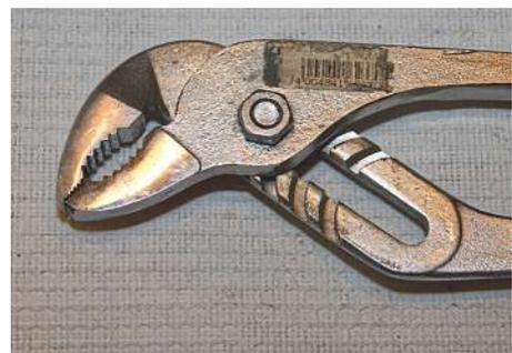
**Bild 1.3** Wie billig verarbeitet diese Rohrzanze ist, zeigt sich bereits an der Backenachse, die aus einer Schraube mit Mutter besteht.
