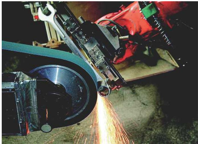
**Bild 1.10** Bei qualitativ hochwertigen Werkzeugen werden zudem Kanten und Grade sorgfältig abgeschliffen.
