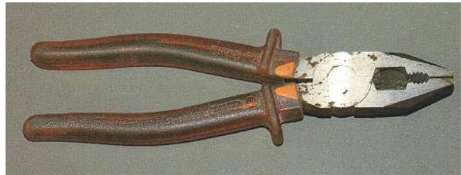
**Bild 1.18** Bis auf die bewährte Kombizange sollte man sogenannte Kombinationswerkzeuge nicht kaufen bzw. verwenden.
