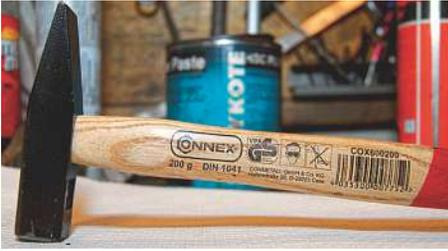
**Bild 1.29** Auf guten Werkzeugen findet man stets eine DIN-Norm und gegebenenfalls das GS-Zeichen.
