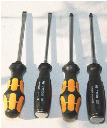
**Bild 1.13** Ergonomisch geformte Werkzeuggriffe erleichtern das Arbeiten ungemein. Bei diesen Schraubendrehern verhindern sie auch das Wegrollen.
