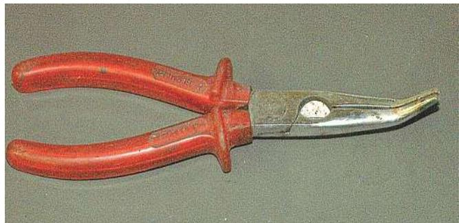
**Bild 1.20** Bei Spitzzangen ist die Verwindungssteifigkeit der Backen zu prüfen. Die Qualität der Backenachse ist hierfür entscheidend.
