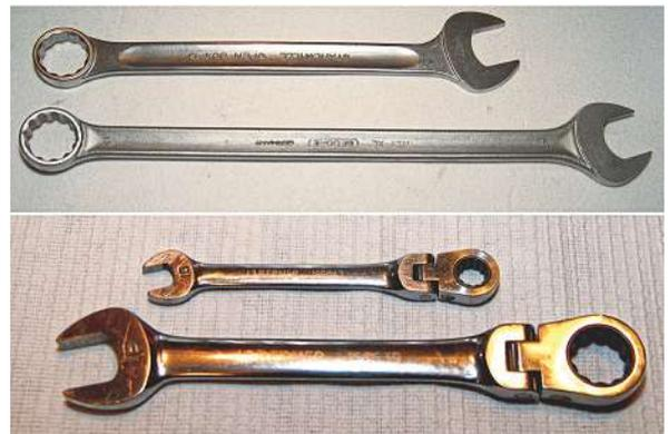
**Bild 1.12** Hochglanzpolierte Werkzeuge wie die oberen sind zwar leicht zu reinigen, jedoch rutscht man an ihnen mit öligen Händen schnell ab. Raue Werkzeug-Oberflächen bieten dagegen mehr Halt beim Arbeiten, wenn die Hände ölerschmiert sind.
