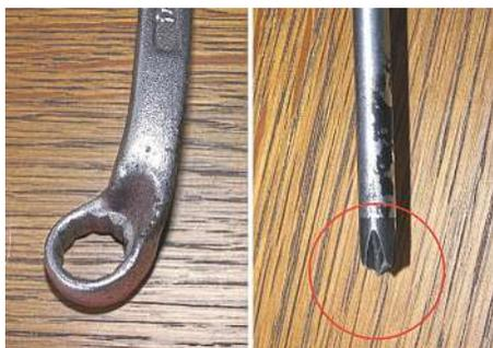
**Bild 1.2** Billige Baumarkt- und Discounterware: Der Kreuzschlitz-Schraubendreher ist beim Öffnen einer Plastikschraube (!) abgebrochen, der Ringschlüssel hat sich beim Öffnen einer Ölablassschraube verbogen.
