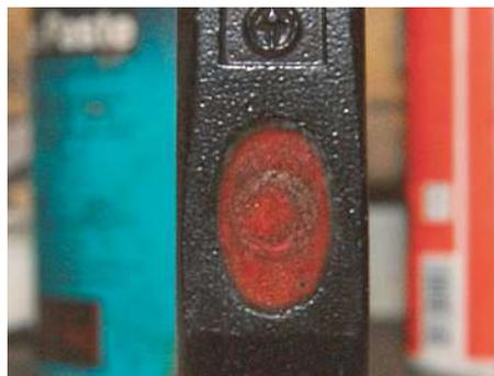
**Bild 1.23** Bei hochwertigen Hämmern wird der Holzstiel im Hammerkopf gleichmäßig durch eine Einschlagtülle verpresst. [13]
